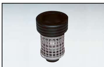
Sikkerhedsventil til sikre løft med f.eks. fast værktøj (krog). Monteres mellem løfteslange og vakuumhus. Fjerner straks undertrykket i løfteslangen ved utilsigtet frigørelse af lasten.
