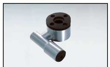
Udløserventil. Letter frigørelse af lasten ved brug af store sugefødder, f.eks. ved vertikale løft. Fås til både standard og forlænget styreenhed.
